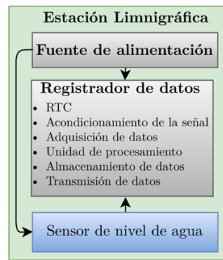
Figura 5. Estructura general de una estación limnigráfica con sensor de nivel de agua.
