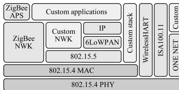
**Figura 1.** Protocolos para redes inalámbricas de sensores [11].
