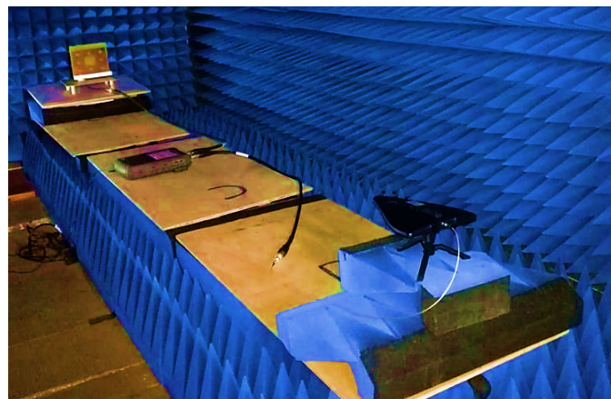
Figura 13. Escenario durante las mediciones de la ganancia de la antena fractal.
