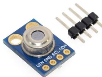
**Figura 4.** Sensor de temperatura infrarrojo MLX90614.
