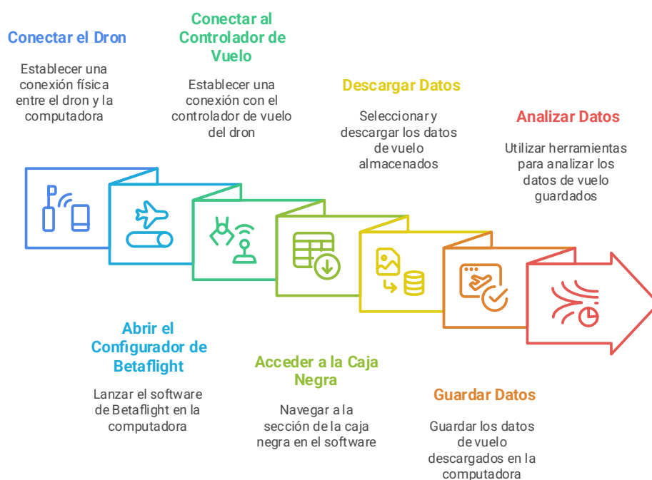
Figura 1. Proceso de obtención de los datos almacenados en la caja negra del cuadrotor. Fuente: Elaboración propia.
