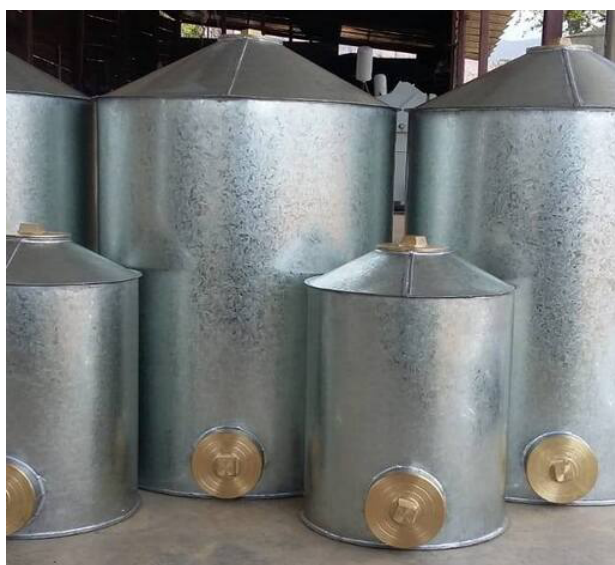
Figura 4. Ejemplos de silos metálicos de almacenamiento. Fuente: Basado en [18].
