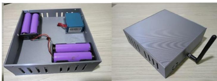
**Figura 9.** Prototipo construido. Fuente: Elaboración propia.
