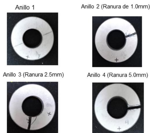
**Figura 3.** Anillos piezoeléctricos PZT-4, Anillo 1 completo, Anillo 2 con una ranura de 1.0 mm, Anillo 3 con ranura de 2.5 mm y Anillo 4 con ranura de 5.0 mm.
