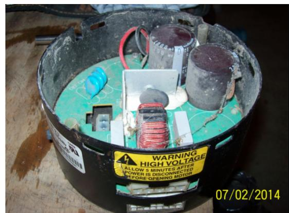
Figura 18 Tarjeta electrónica dañada.
