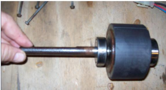
Figura 20 Rotor con 3 imanes permanentes.
