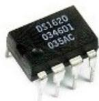
Figura 30 DS1620 sensor de temperatura.
