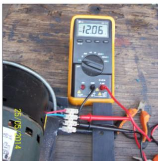
Figura 22 Respuesta del generador 12VCA a 35 rpm.
