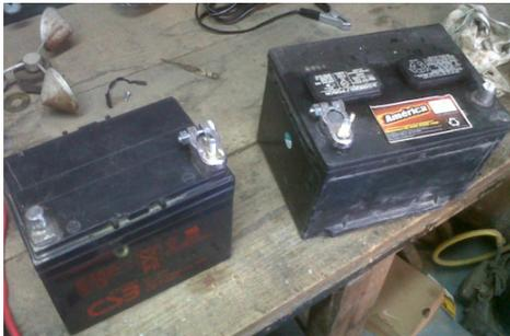
Figura 7a Baterías plomo-ácido, utilizadas en el sistema.
