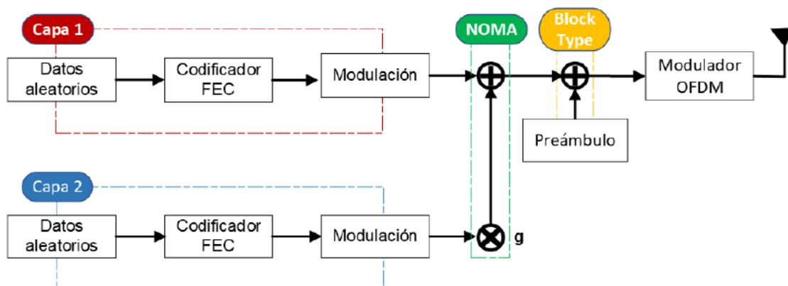
Figura 1. Diagrama de bloques del transmisor NOMA – OFDM.
