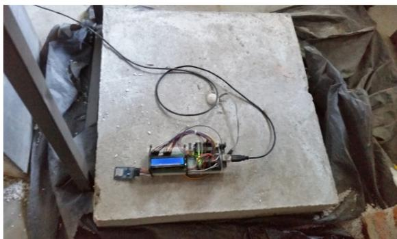
**Figura 1** Arduino con Display, memoria Secure Digital (SD) y con sensor DHT22 en una losa de concreto [9].
